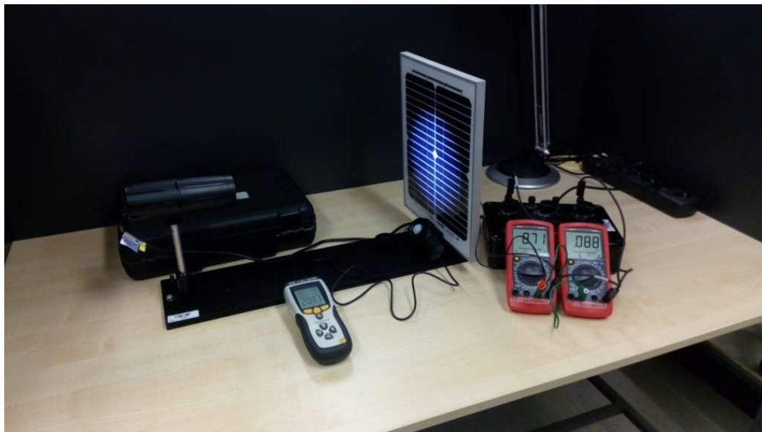
Obr. 1 Měření voltampérové charakteristiky solárního článku
