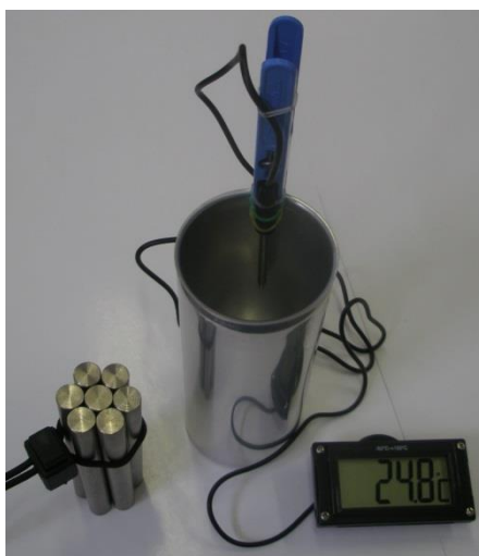
Obrázek 3. Uspořádání experimentu - vlevo jsou kovové tyčky sepnuty gumovým vláknem, zajištěny brzdíčkou a připraveny pro vhození do vody.
