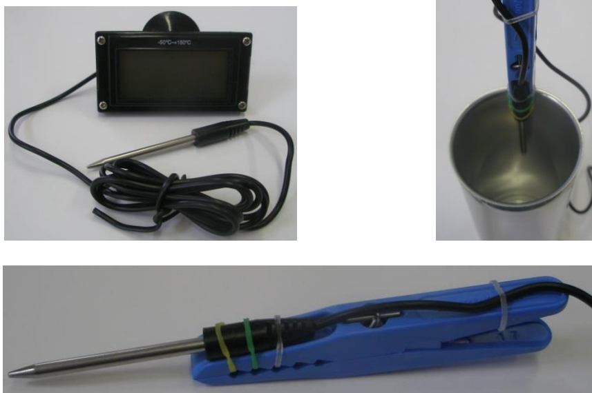
Obrázek 2. Teploměrné čidlo a jeho připevnění na kolíček a plechovku.
